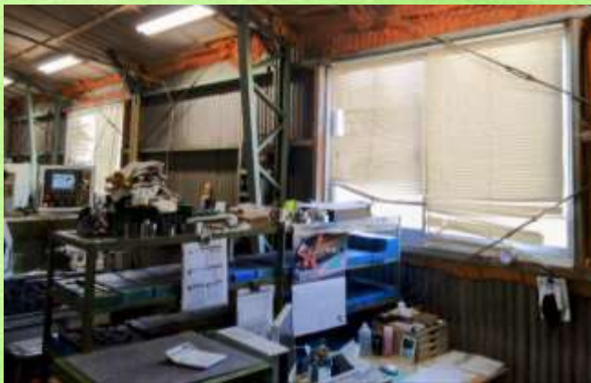
第2工場の窓を遮熱塗料で塗装し断熱効果で夏の暑さ対策を行いました
