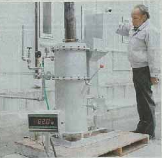
破碎した草や木をそのまま燃料として使用できるドコーのバイオマス燃焼器
